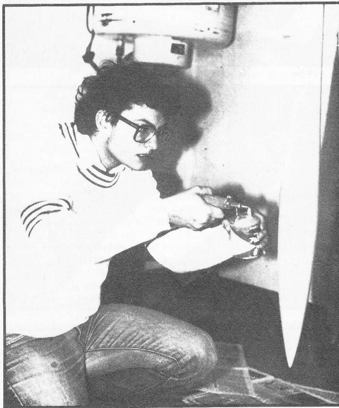
Pulvérisation d'une dernière couche d'apprêt de carrossier sur la forme du Jazz, avant ponçage final du papier de verre à l'eau qui donnera un aspect glacé au modèle. L'état de surface du moule dépend de la préparation de modèle, ne l'oublions pas!
