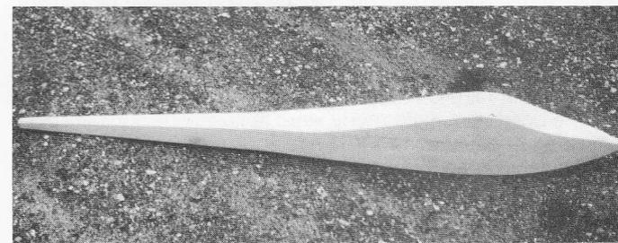
*Le modèle après la découpe suivant la vue de dessus. La forme se précise, il ne reste plus qu'à arrondir!*
